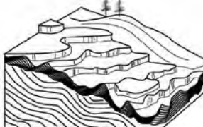
Teras tipi traverten morfolojisinin blok diyagramındaki şematik görünümü
